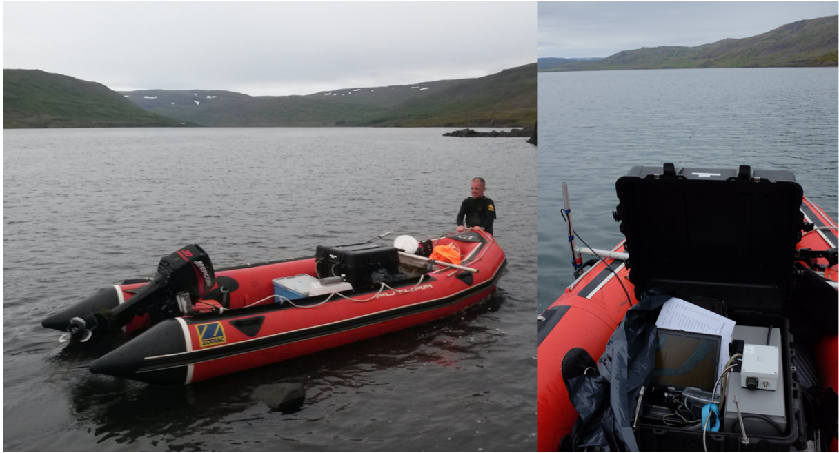
7. mynd. Slöngubáturinn ásamt botnstykkinu sem notað var við bergmálmælingar í Þorskafirði í frumathugun Hafrannsóknastofnunar í ágúst 2015 (ljósm. Hlynur Pétursson).
